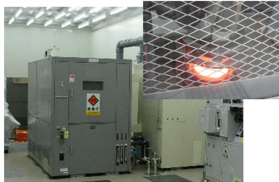
Power supply: 150kHz, 100kW
